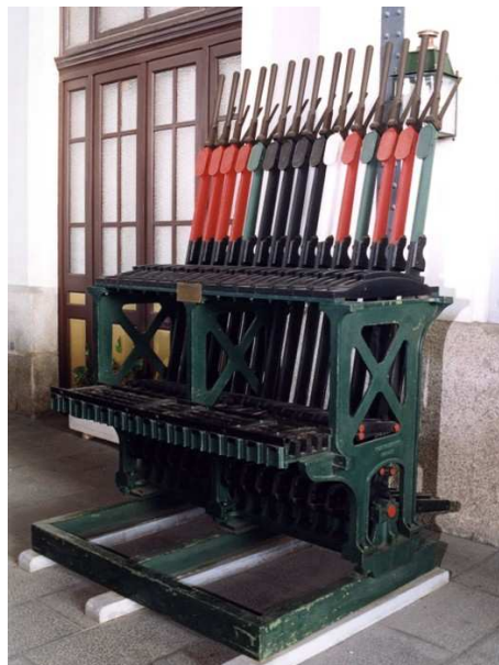
Fig. 60 enclavamiento mecánico Saxby Farmer fabricado en Gran Bretaña el año 1882.
