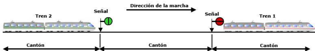
Fig. 53 Señales semafóricas protegiendo secciones de vía o cantones.
