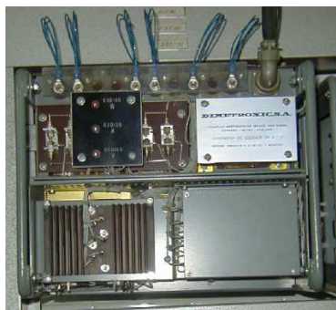
Fig. 69 Generador de Códigos de ATP en La Pau L4.
