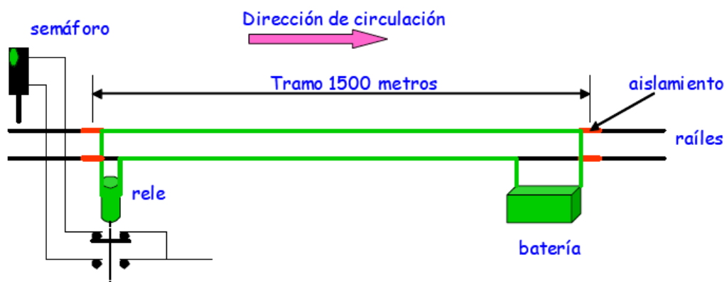
Fig. 5 Esquema simplificado de un CV libre.
