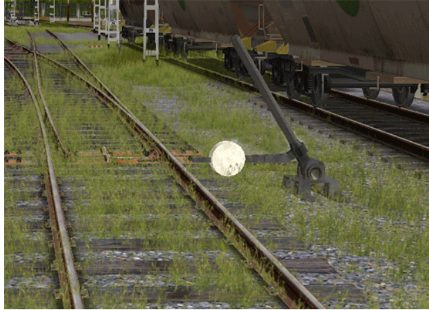
Fig. 47 Accionamiento manual con marmita en un cambio de agujas.
