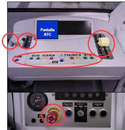
Fig. 164 Mandos del material rodante en el sistema CBTC.
