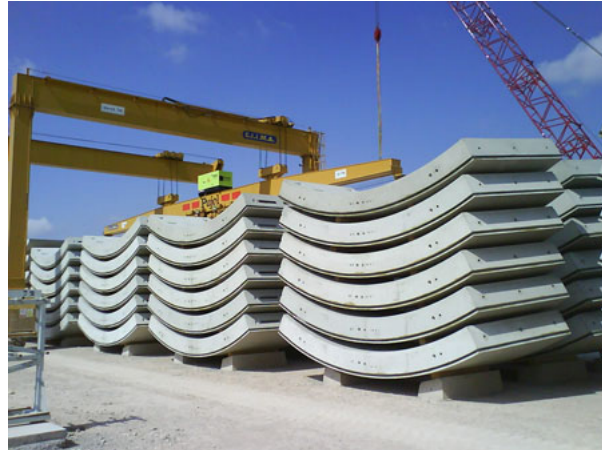
(b) Acopio de dovelas. Fuente: [S]
