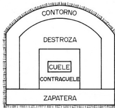
Figura 26: Esquema de voladura. Fuente:[13]
