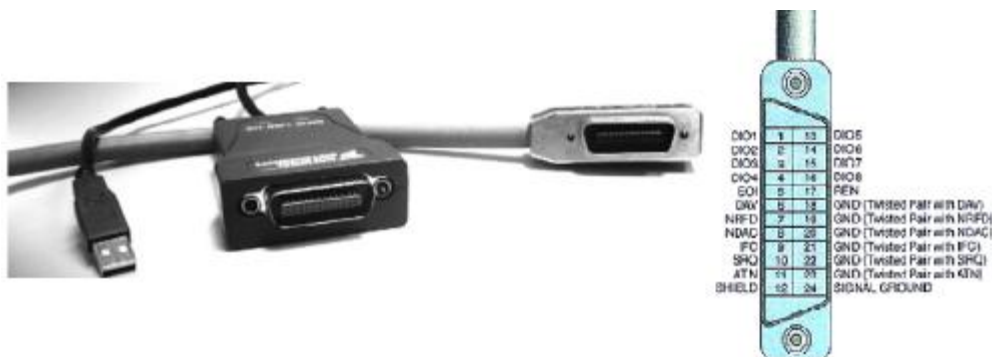
Figura A.2 Controlador GPIB amb interfase USB i el pinout del bus GPIB [16]
