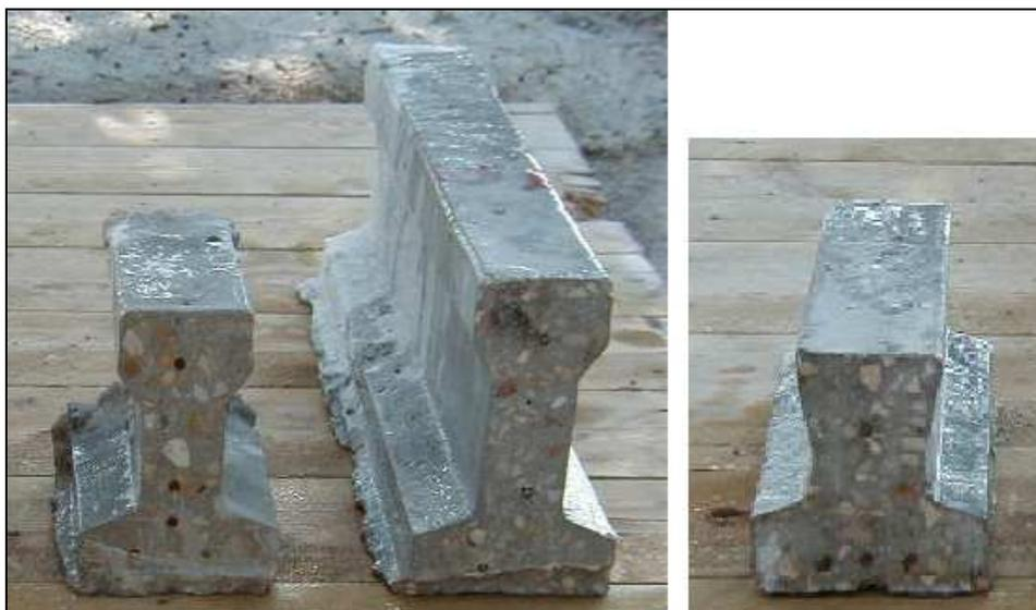
Figura 1.3. Secciones de viguetas T-16, T-18 y T-11 (de izquierda a derecha)
