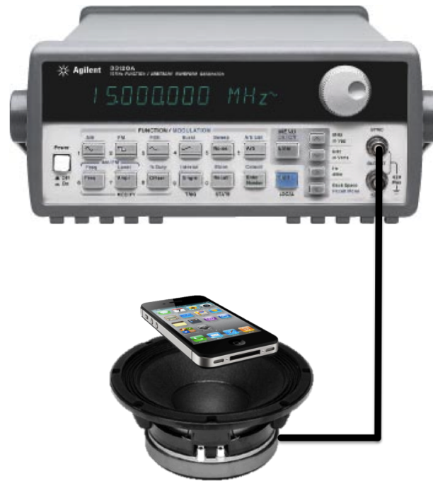
Figura 5.1: Esquema del sistema mecánico utilizado para generar un latido cardíaco de forma controlada.
