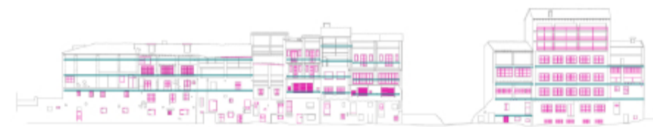
oberturas actuales - forjados nuevos
