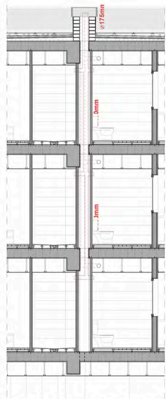
Detall del pas del tubs de ventilació (general + addició) a través del conducte tècnic
