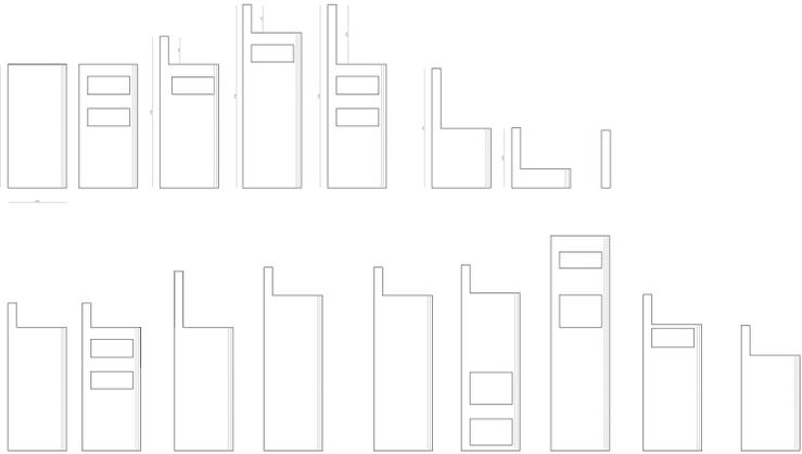
Los paneles LENO están formados por capas alternadas de listones de Abeto, encoladas al vacío con cola metámina clase E1. Esta constitución confiere una gran estabilidad y resistencia a los paneles LENO. Se fabrican en grandes dimensiones y posteriormente se mecanizan para darle la forma definitiva con las correspondientes aperturas.
