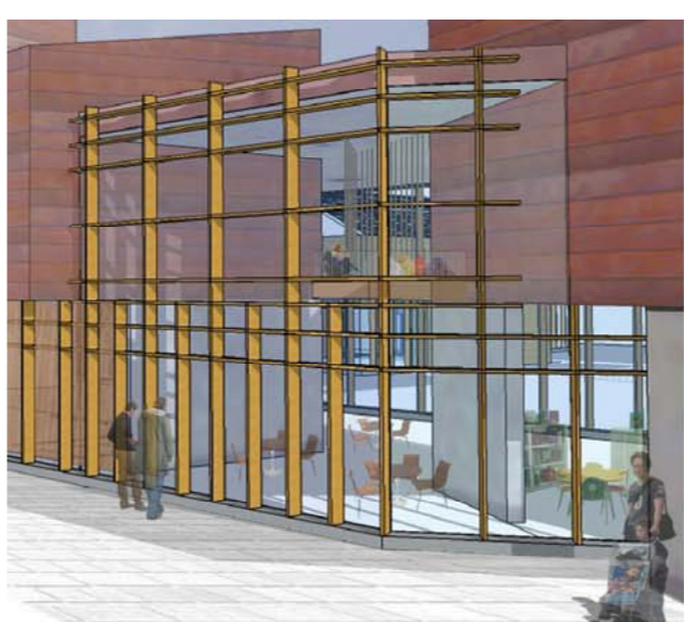
1 CENTRE CÍVIC - SUD (C/Rosés): muntants junts i més lames per a protecció solar.
