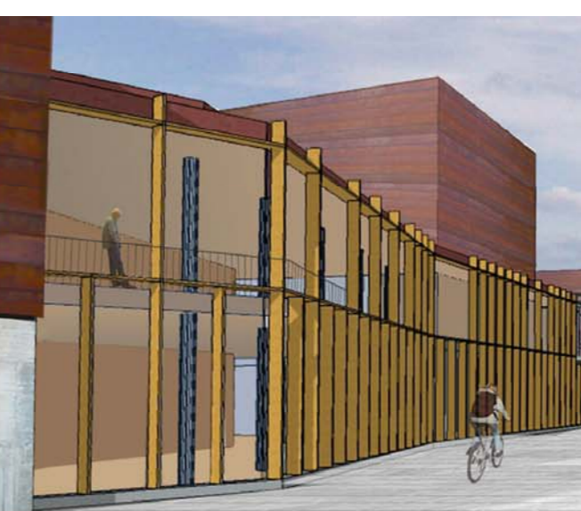
2 CENTRE CÍVIC - NORD (placa): muntants més separats i lames només per a rigiditzar i dirigir les visuals des de l'interior.
