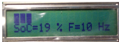
Figura 4. 12 Display LCD mostrando el SoC y la frecuencia de 'señal'.
