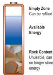
Figura 1. 3 Capacidad de carga de la batería. Tres secciones imaginarias
