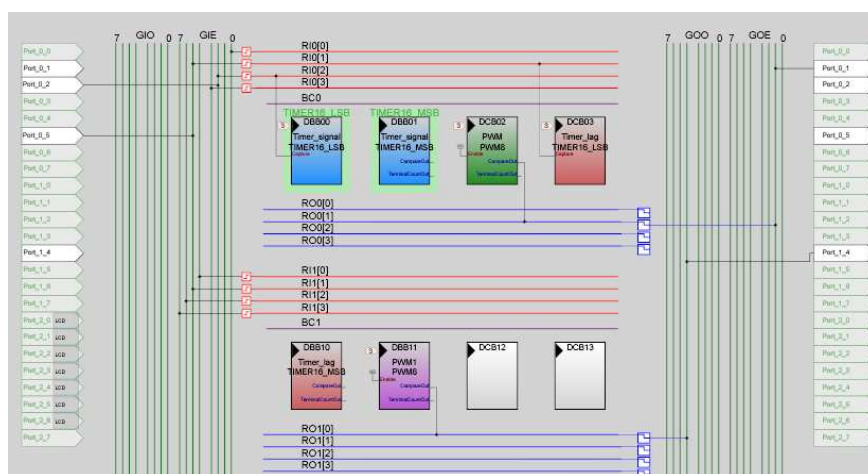
Figura 3. 10 Timers y conexiones en PSOC.
