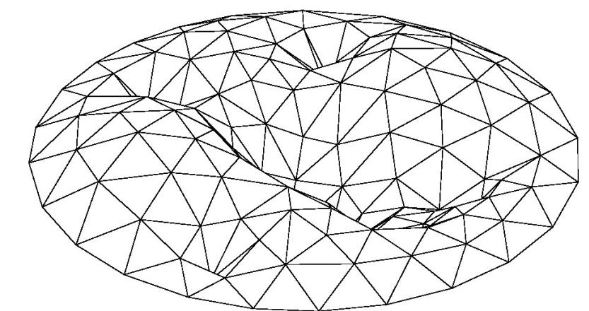
Distribución inicial triángulos equiláteros obtenido mediante remalla topológico a partir de la malla de cálculo
