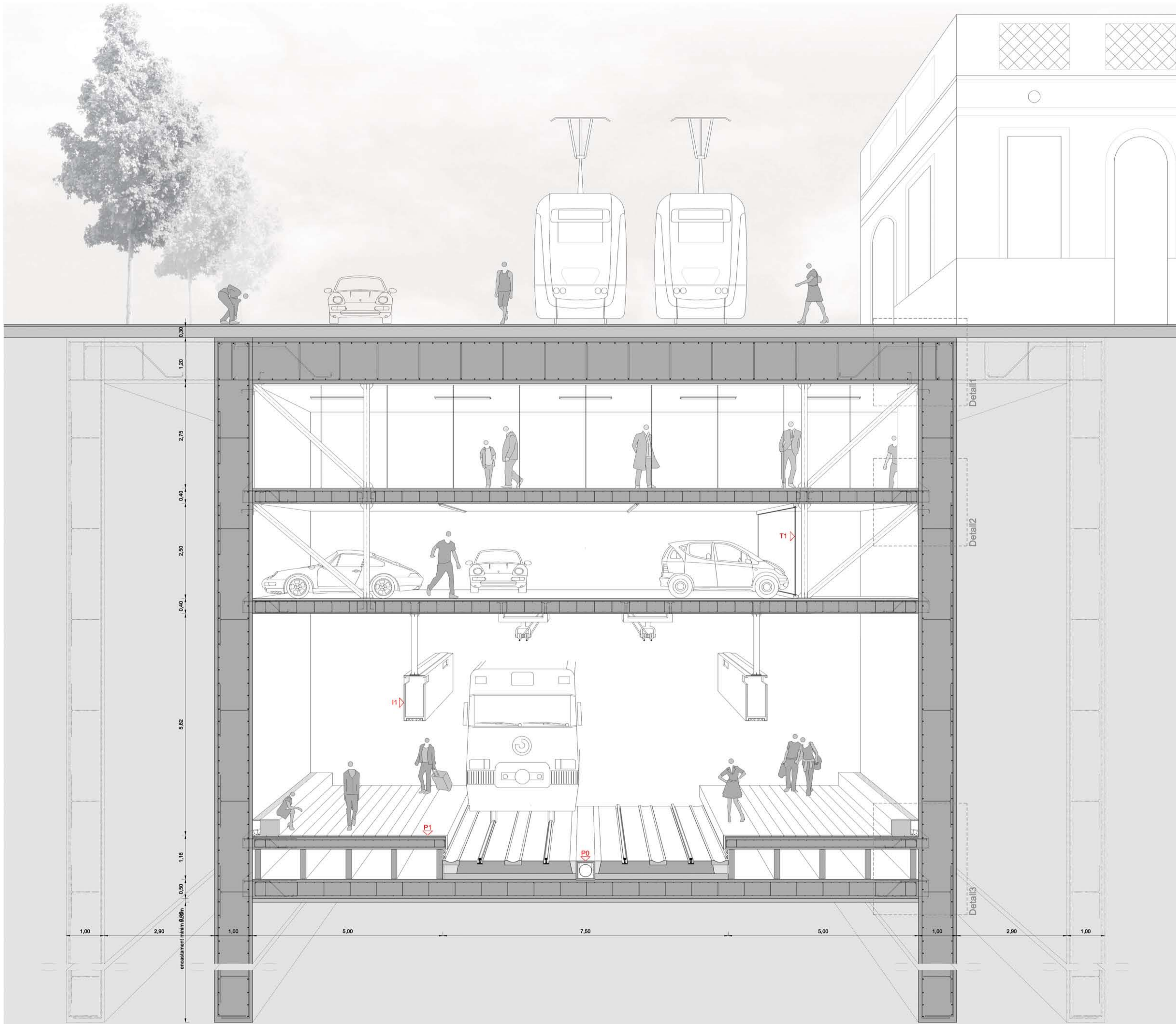
Secció constructiva fugada de l'estació [e 1/50]
